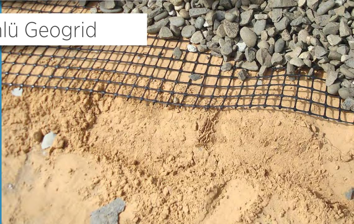
**Fortech GG Tek Yönlü Geogrid**, inşaat mühendisliğinin çeşitli uygulamalarındaki tek yönlü geogrid ihtiyaçları için geliştirilmiş yüksek mukavemetli malzemelerdir. Polyester mikro iplikçiklerin dikdörtgenler şeklinde örülüp, üzerinde PVC ile kaplanması yöntemiyle üretilir. Düğüm noktalarında daha sağlam olabilmesi için özel tasarlanmış bir dikiş yöntemi sayesinde, yüksek performans sağlamaktadır.
